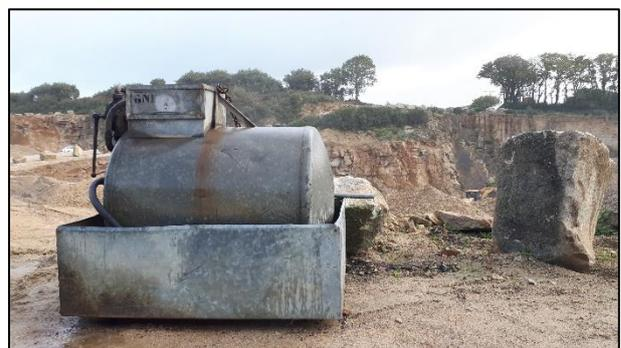
Photographie 8 : Réservoir GNR de 1 000 l sur rétention
