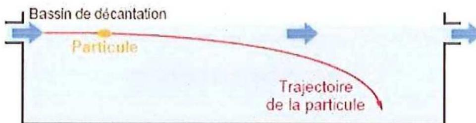
Figure 44 : Schéma d'un décanteur horizontal
