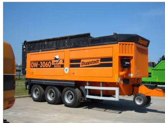
Figure 20 : Miniatures du broyeur mobile DOPPSTADT DW-3060 du groupe GUYOT Environnement
