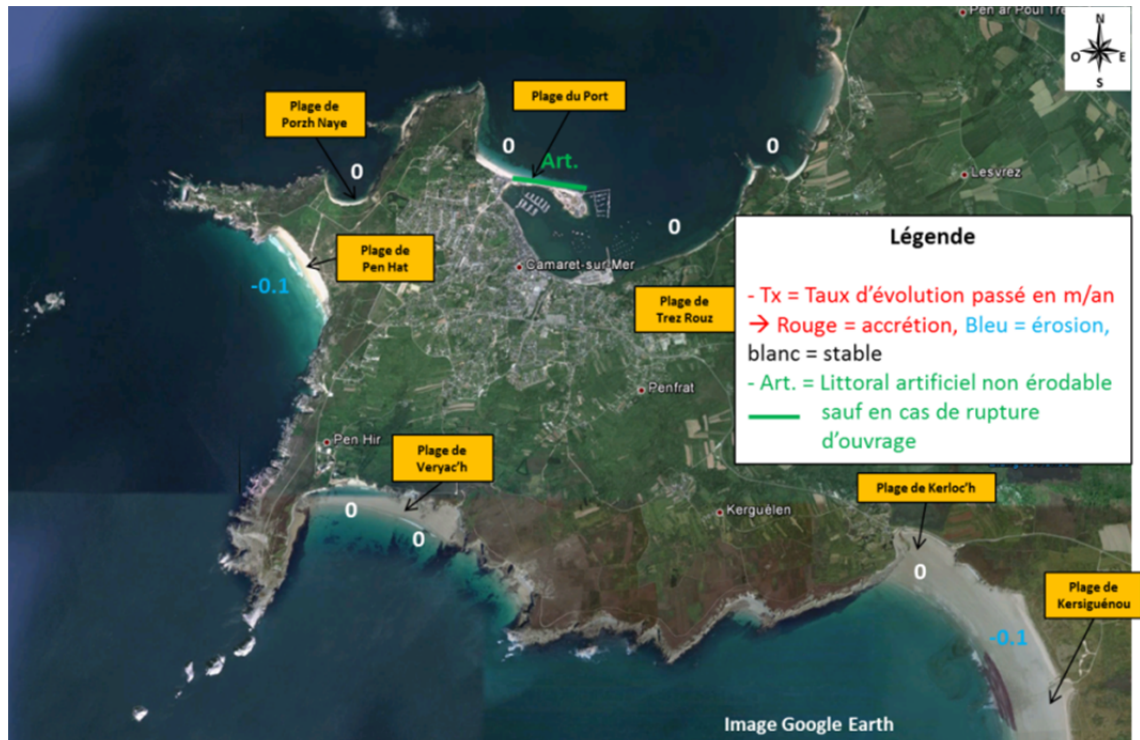
Figure 27 : Carte présentant le recul moyen annuel historique du trait de côte « Tx »
