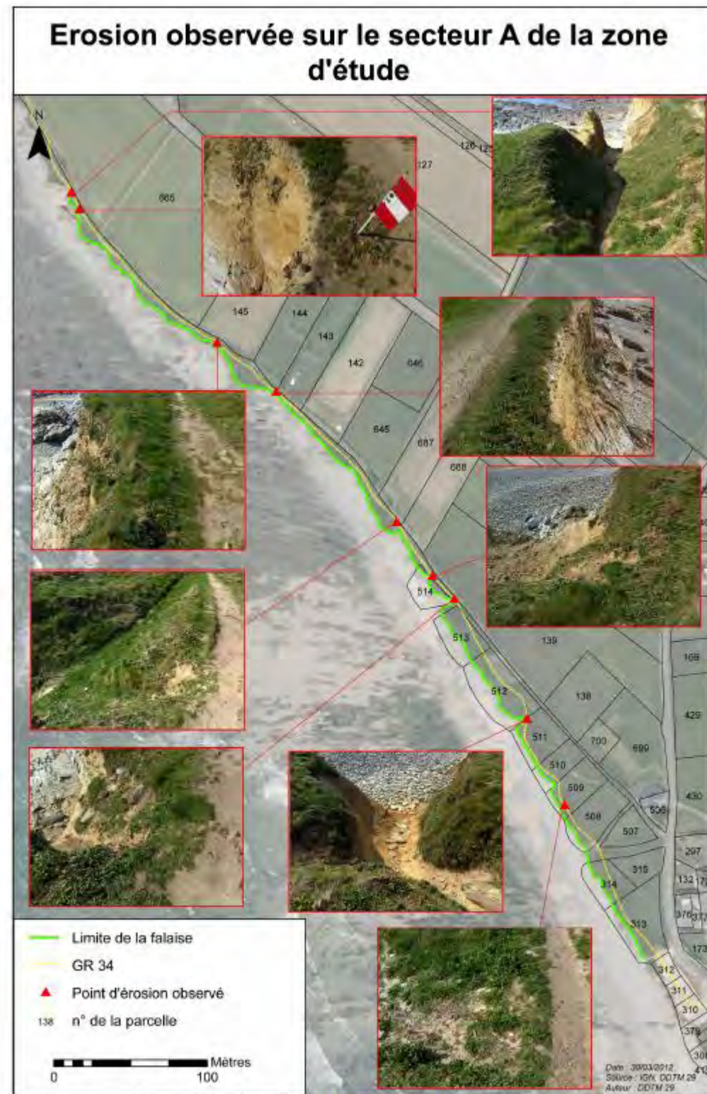
Figure 3 : Points d'érosion observés sur le secteur A
