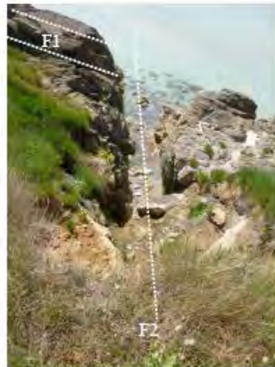
fracturation F2 du massif rocheux entaillant le trait de côte au droit de la parcelle 104
